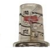
劣化したタンクゲージ
